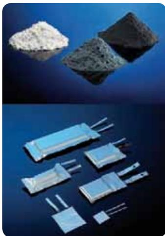
*Nanopoudres et batterie lithium-ion. Les batteries lithium-ion, déjà utilisées pour les ordinateurs portables et les téléphones mobiles, et des associations de nanopoudres de lithium de fer et de phosphate permettront de réduire la taille des batteries.*
