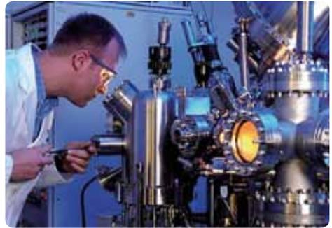
*Un microscope à effet tunnel*
