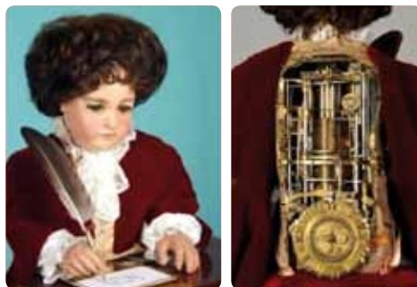
Figure 2 : l'écrivain de Pierre Jacquet-Droz. Cet automate des années 1770 peut écrire des petits messages en utilisant une plume et un encrier.
